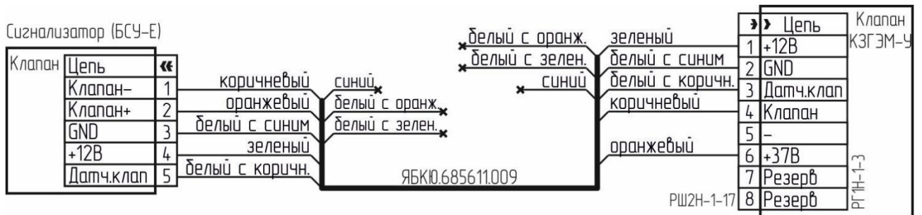
Рисунок VI.9 – Типовая схема подключения клапана КЗГЭМ-У с разъемом РГ1Н-1-3
