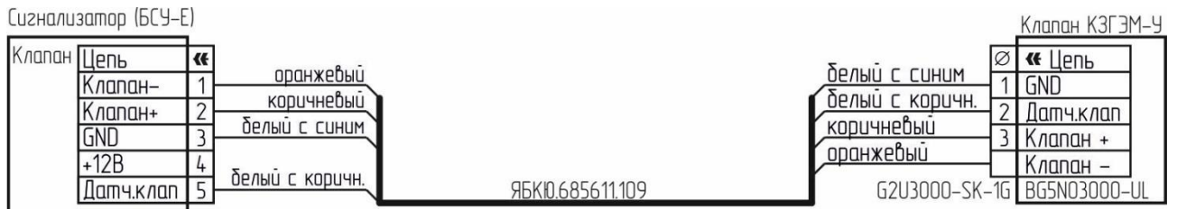
Рисунок VI.8 – Типовая схема подключения клапана КЗГЭМ-У с разъемом BG5N03000-UL
