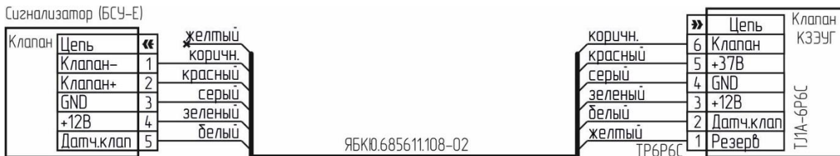
Рисунок VI.3 – Типовая схема подключения клапана КЗЭУГ с разъемом ТJ1А-6Р6С
